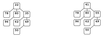
binomial tree: yes binomial heap: yes! binomial tree: yes binomial heap: no!
